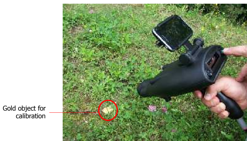
شکل ۶.۹ : کالیبره کردن دستگاه روی شیء طلا در حالت Ionic
