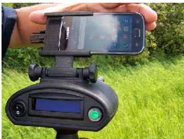
شکل ۵.۴ : قرار دادن گوشی هوشمند روی نگهدارنده
