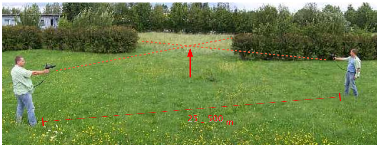
شکل ۶.۵ : سه گوشه سازی با Bionic X4
