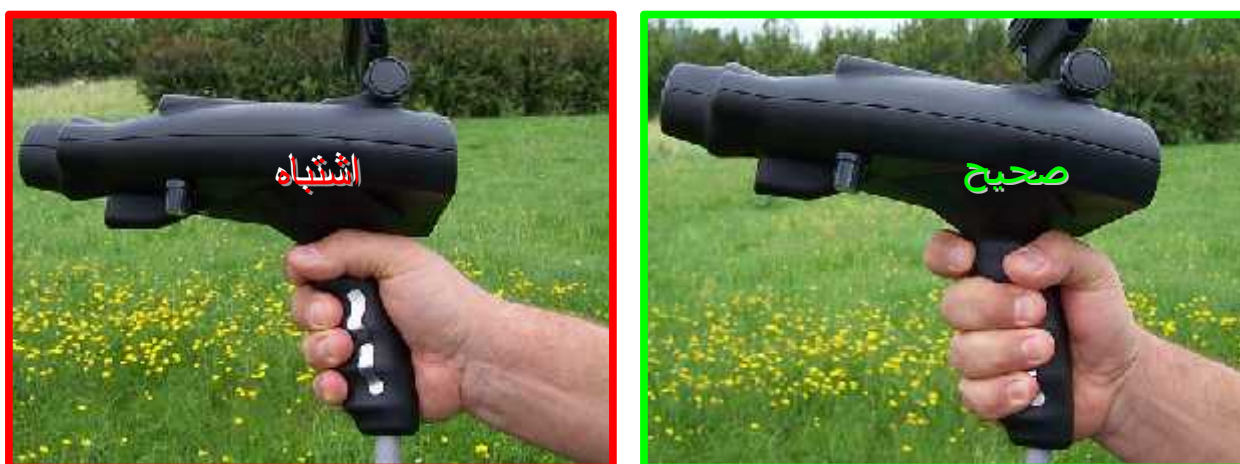
شکل ۶.۲ : تماس بین دست اپراتور با الکترودها
